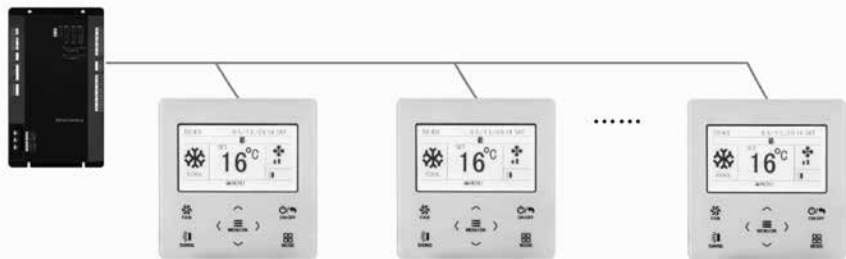
Schemat instalacji komunikacji bramki BACnet - sterowniki XK76
